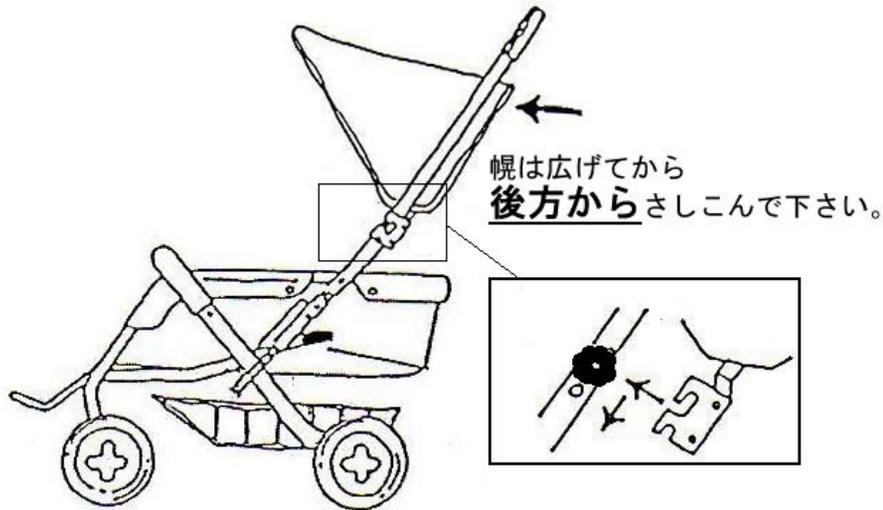
取り付け金具を、図に従ってノブボルトで固定します。
