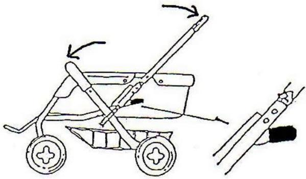
車体を閉じている開き止めフックを外し、車体を左右に開きます。広がった時にフックが掛かった事を確認して下さい。
