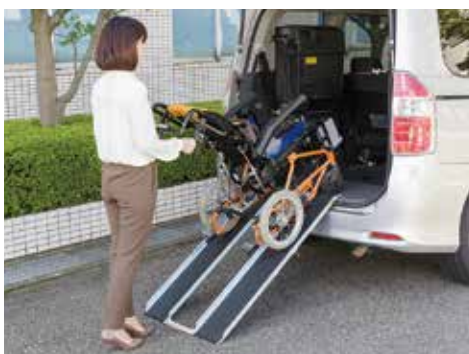
⑤ 車いす・バギーをしっかりと 支えて押し上げる
