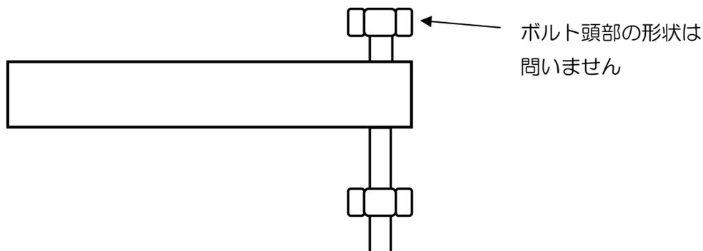
4. ヘルスマーター押さえプレートの上に重量伝達フレームを載せビームにボルトを均等に締めてください。
