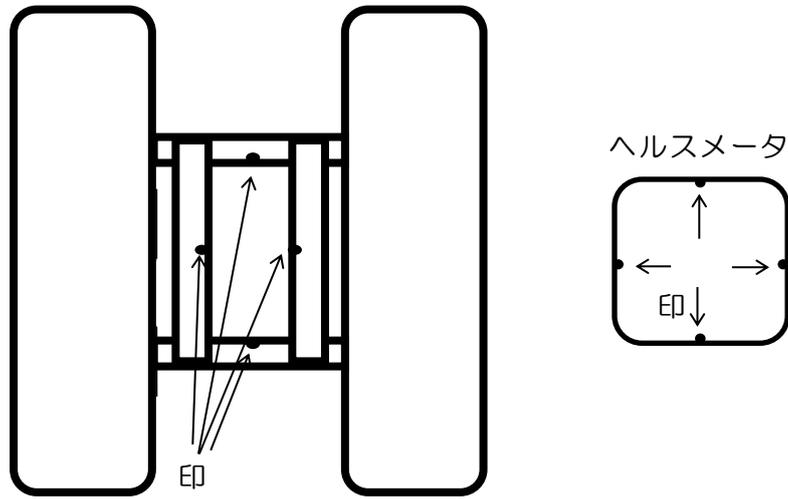
5. ヘルスマーター押さえプレートの上に重量伝達フレームを載せビームに均等にしっかりと8本のボルトをしめてください。
