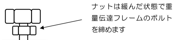
5.重量伝達フレームが反らないように均等にボルトを締めてください。
